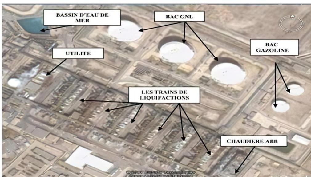
Figure I. 2 Plan d'implantation du complexe GNL2/Z.
