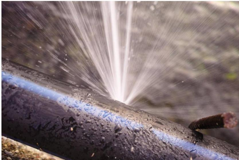
*Figure I.3.1. Fuite dans un pipeline*
