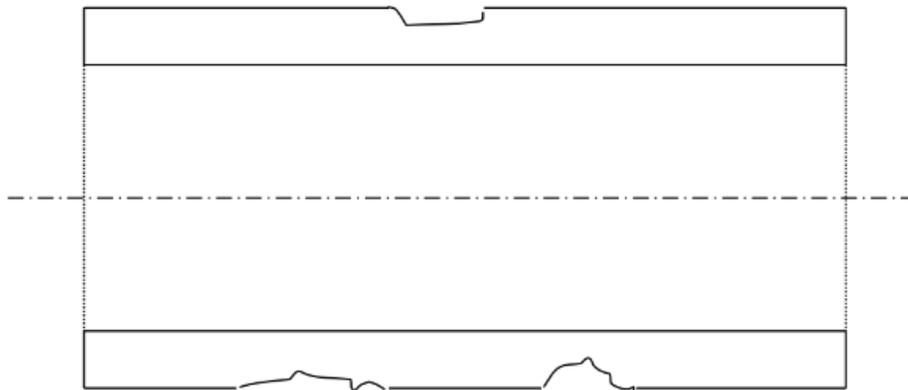
Figure I.3.3. Schéma simple d'une corrosion externe
