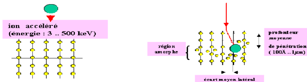
Figure A.9 : Procédé de l'implantation ionique.
