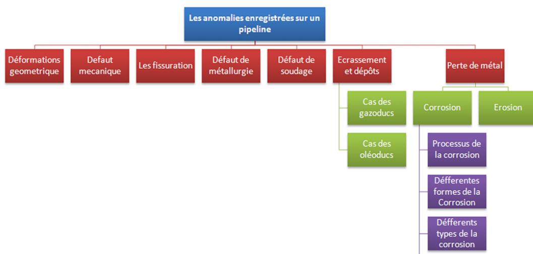
Figure II.1.1: Anomalies liées au transport par canalisation.
