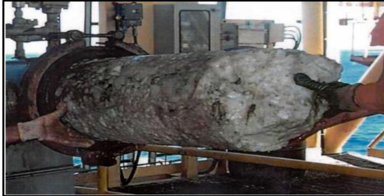
Figure2-6 : Hydrate sorti d'une gare racleur
