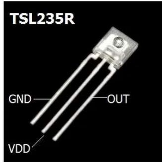
Figure III.6 : Capteur TSL235R.[70]
