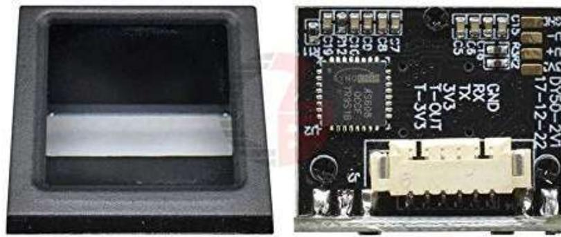
Figure III.11 : Les boches du capteur d'empreinte digitale GT511C3.[73]
