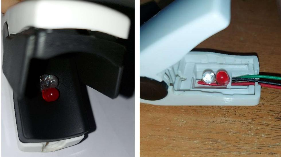
Figure III.4 : La placement du LED rouge et infra rouge dans l'oxymètre
