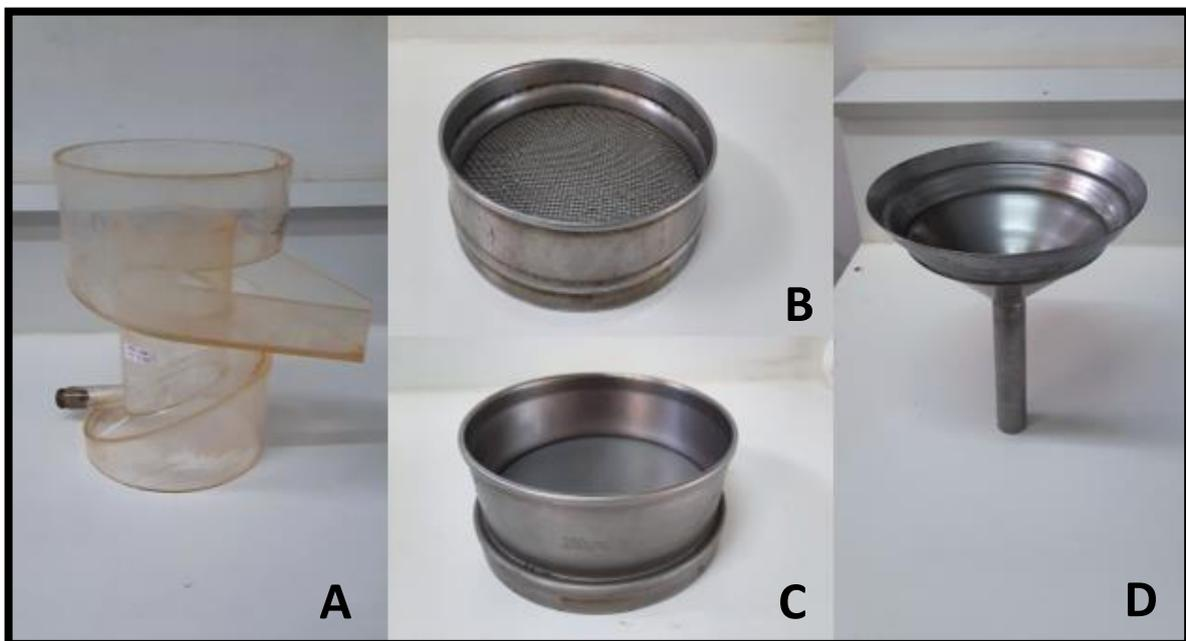
**Figure 16 Appareil de FENWICK (A)- Corps de l'appareil, (B)-Passoire de 1mm, (C)- Tamis 250 µm, (D)-Entonnoir. (Original).**
