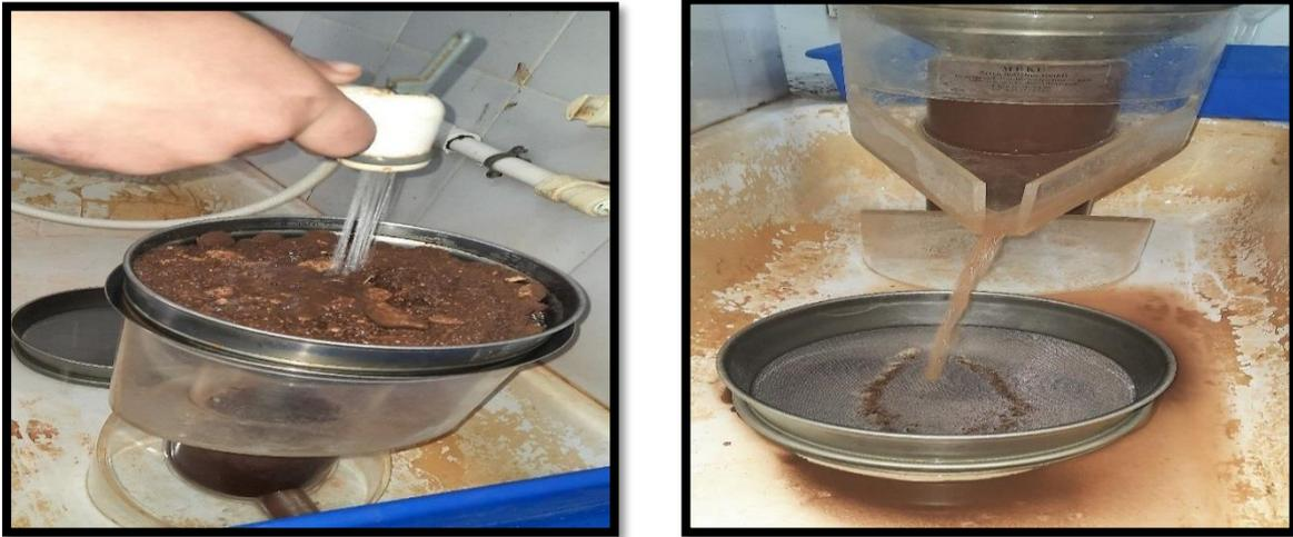
**Figure 17** Ecoulement du refus sur tamis de 250  $\mu\text{m}$  (Original)
