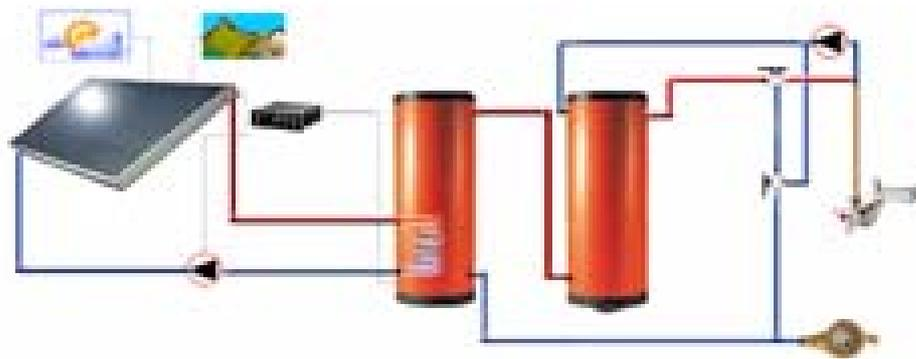
Figure III.4 chauffe eau avec échangeur interne et appoint centralisé séparé [21]
