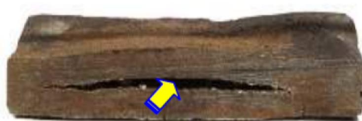
FIGURE 2.12 – La fragilisation par hydrogène d'une pièce métallique.
