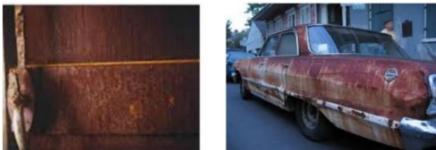
FIGURE 2.3 – Corrosion généralisée : exemple d'une d'une porte et d'un véhicule corrodés.
