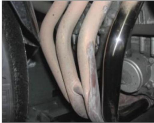
FIGURE 2.1 – exemple de la corrosion d'un collecteur d'échappement
