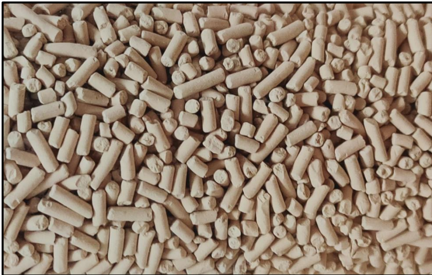
Figure III-11 : Tamis moléculaires utilisés au niveau du complexe GPI/Z
