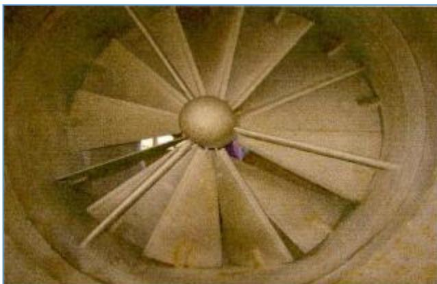
Figure II.4 : Régulateur de la turbulence [26]
