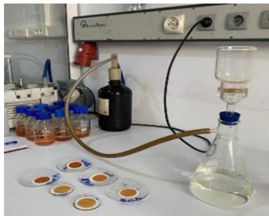
Figure N°IV.10: Filtration sous vide des échantillons pour différents taux de mélange.
