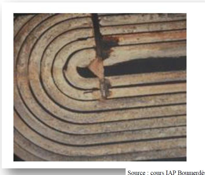
*Figure II-13: Corrosion sur un échangeur côté process.*
