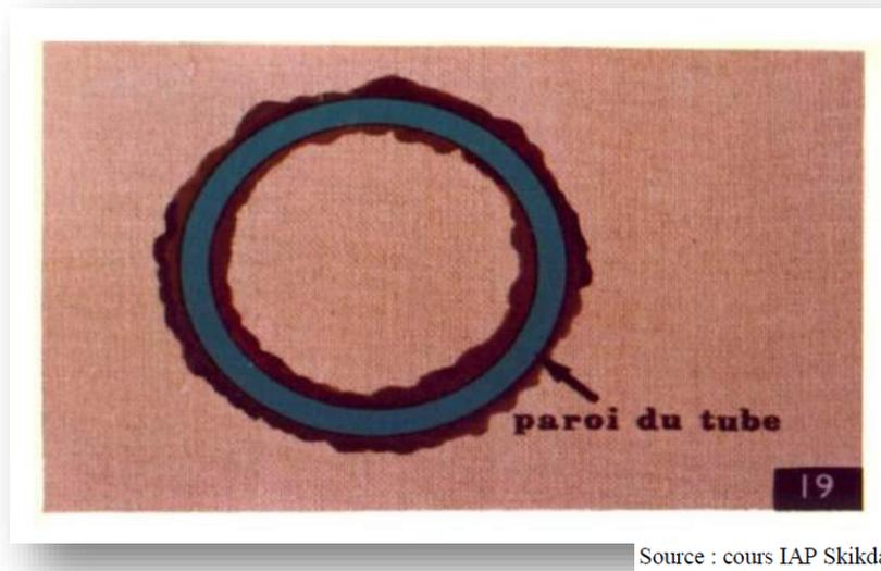
*Figure II-14: Entartage d'un tube.*
