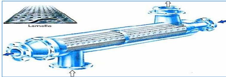
Figure II.12 : Echangeur lamellaire
