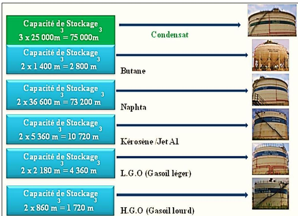
Figure I.4 : Capacité de Stockage des différents Produits au complexe RA2K.
