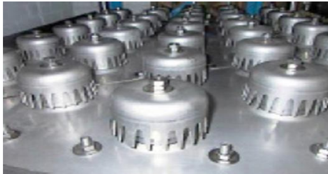
Figure 3-5 : Plateaux à cloches (Interne de colonne)
