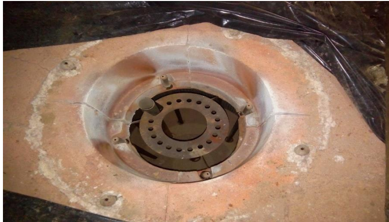
Figure 3-8 : Bruleur a double étages Four RA2/K
