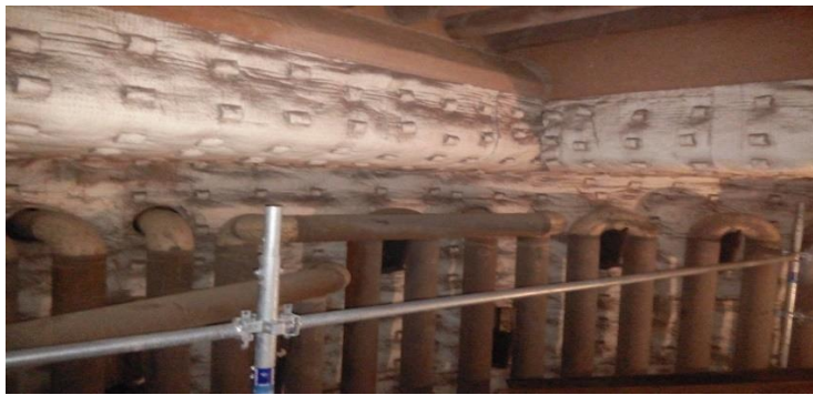
Figure 3-2: La couche réfractaire Laine de verre Four RA2/K
