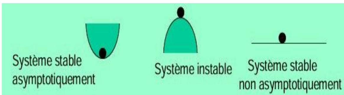
Figure III. 1 : la position d'équilibre d'un système.
