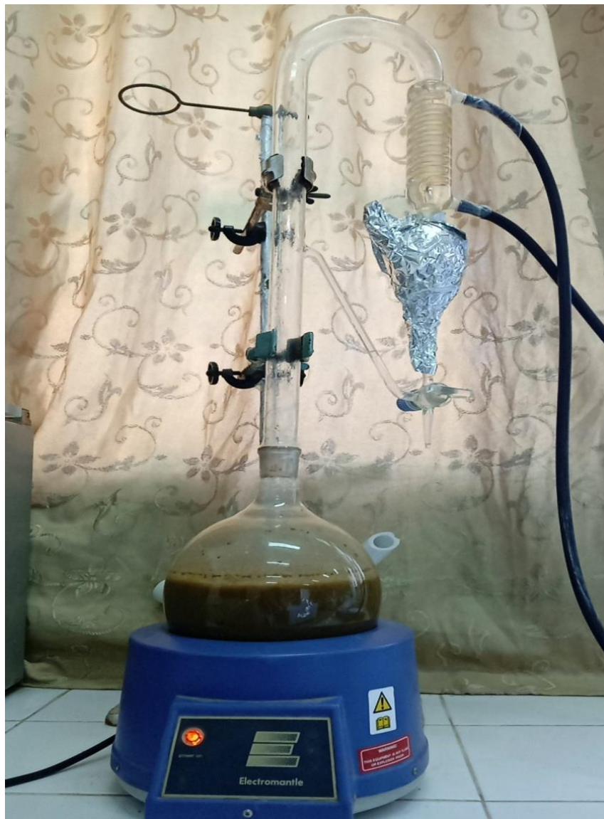
Figure N°IV.9 : Montage utilisé dans l'extraction par hydrodistillation de l'huile essentielle de F. vulgare
