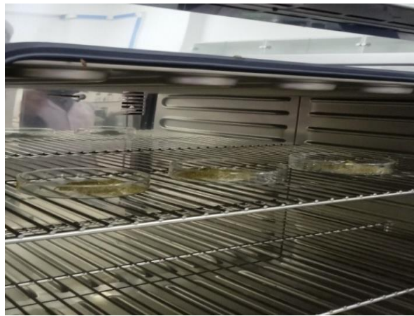
Figure N° IV.4 : Etuvage de la poudre des graines de fenouil.
