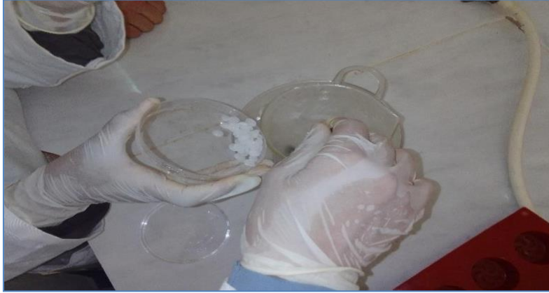
Figure 14 : le mélange l'hydroxyde de sodium avec l'eau distillée
