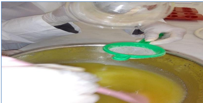
Figure 15 : l'ajout de la solution NaOH sur le mélange des huiles
