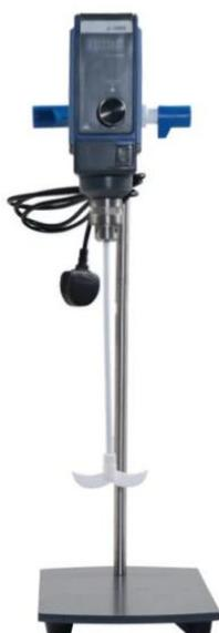
Figure III. 15 : Agitateur électrique.
