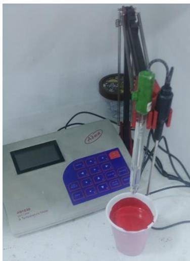
**Figure III. 3 :** Mesure le pH l'encre d'impression.
