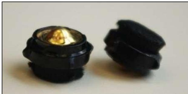
Figure 20: Le capteur utilisé dans le casque EEG Emotiv EPOC.
