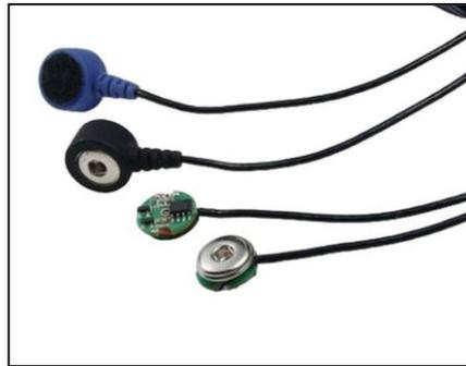
Figure 15 : Les électrodes actives.
