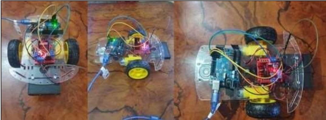
Figure 36 : Prototype miniature d'un fauteuil roulant électrique.
