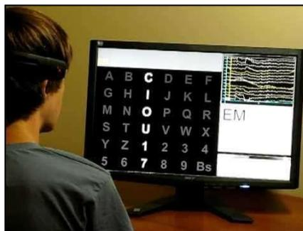
Figure 25: Exploitation d'Emotiv EPOC dans la P300 Speller Machine.
