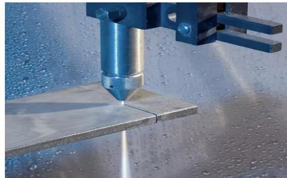
Figure II-3: Découpage jet d'eau [5]
