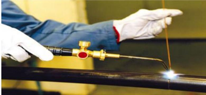
Figure II-20: Soudure au chalumeau [18]
