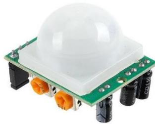
Figure III-10: Capteur de mouvement
