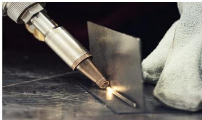
Figure II-21 : Soudure laser [18]
