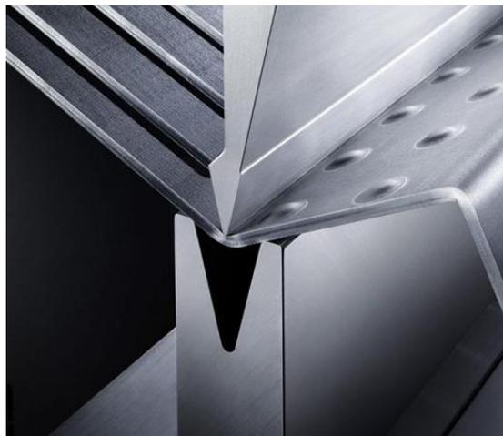
Figure II-10 : Pliage de tôle [11]
