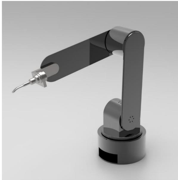
**Figure IV-21:** Robot a 3 DDL de Soudage
