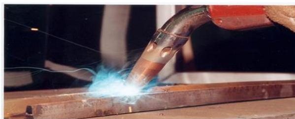
Figure II-19 : Soudure MIG/MAG [18]
