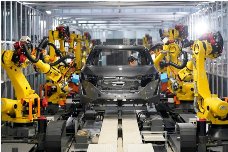
Figure III-14: Robots d'assemblage automobile [29]
