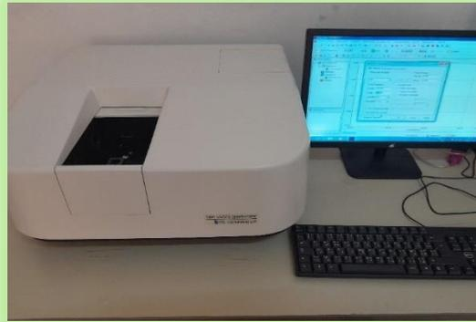
**Photo 05** : Appareil spectroscopie FTIR. ( Institut algérienne de pétrole)
