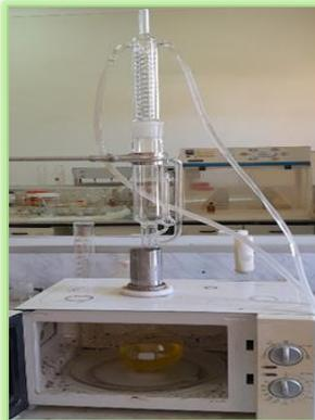
À la fin de l'extraction, Retirez la cartouche de la cellulose, la chaleur est appliquée, les solvants s'évaporent, permettant ainsi de récupérer les composés extraits dans un extracteur Soxhlet.
