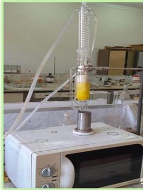
Extraction d'huile de germe par appareil de Soxhlet avec plusieurs cycle a été répété jusqu'à l'épuisement complet.
