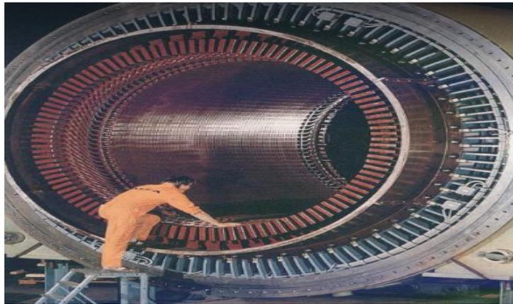
**Figure II-3** : Stator de la machine synchrone [9]
