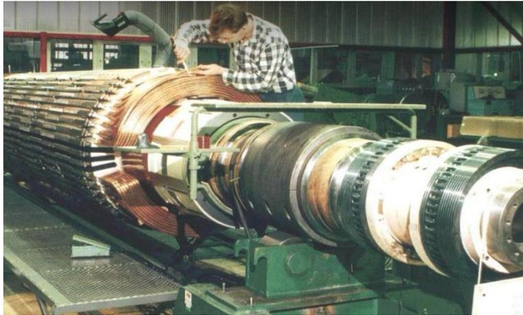
**Figure II-4** : Rotor de la machine synchrone [9].
