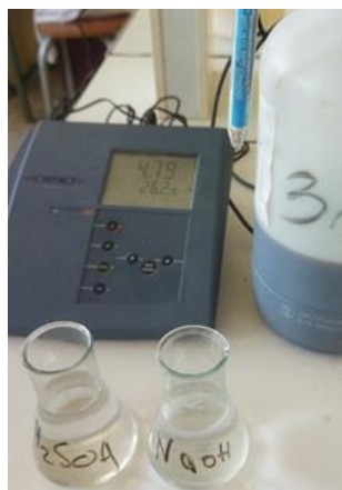
Figure 20 : Ajustement du pH par des solutions et mesure par pH-mètre (photo originale)
