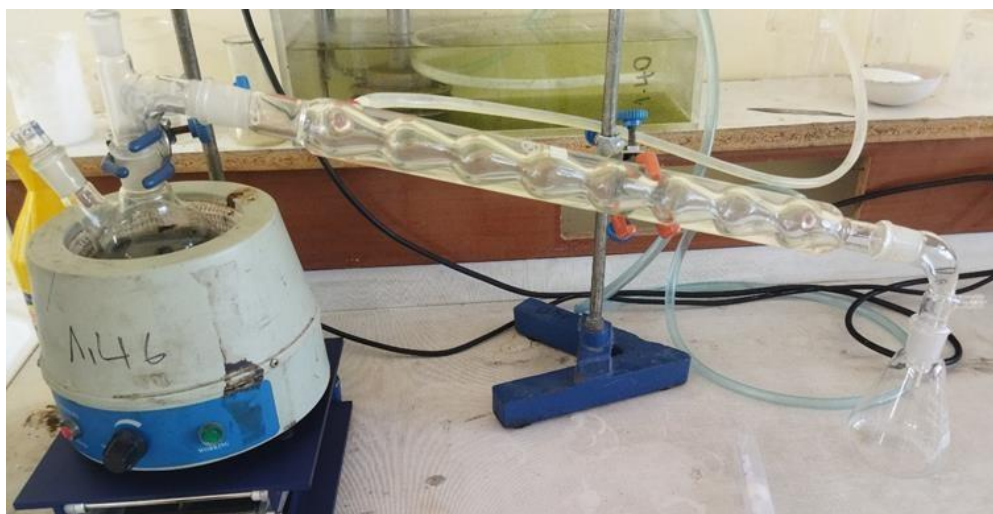
Figure 22: Montage de distillation de laboratoire utilisé (photo originale)
