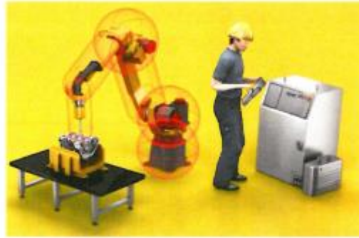
Figure 1 : Zone protégée par une enceinte de protection
