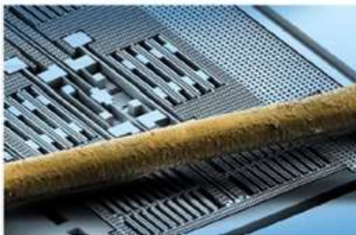
Un microscope électronique montre la structure de silicium finement gravée d'un capteur d'accélération Bosch
