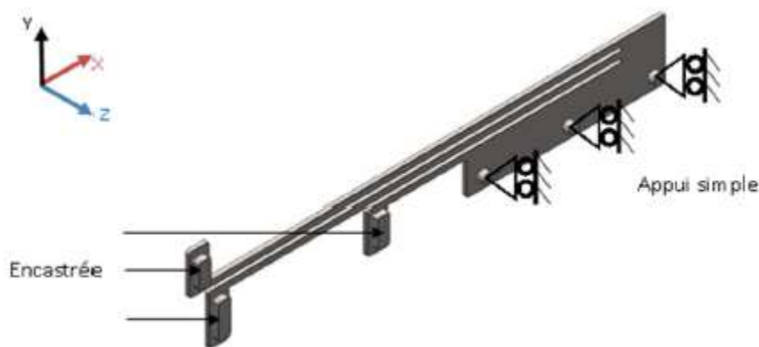
Figure IV.19 : Conditions et contraintes structurelles aux limites.
