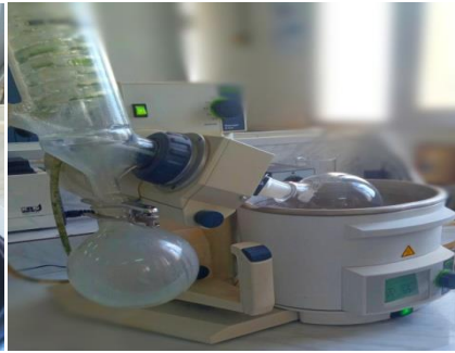
Figure n°43: concentrer le jus pectique dans le rotavapor.
