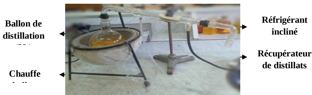
Figure n°25: Installation d'hydro-distillation avec réfrigérant incliné.
