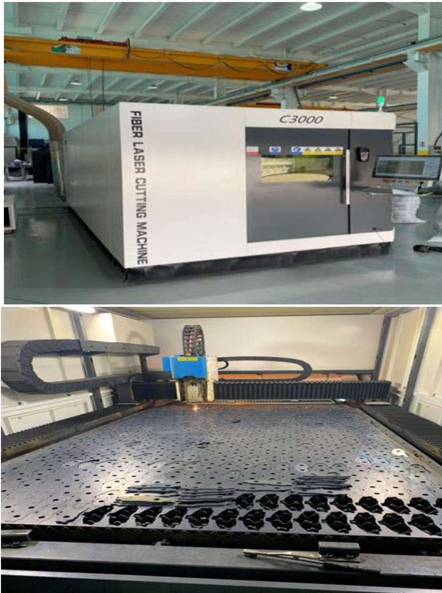
**Figure III.1 : Machine de découpage laser**
