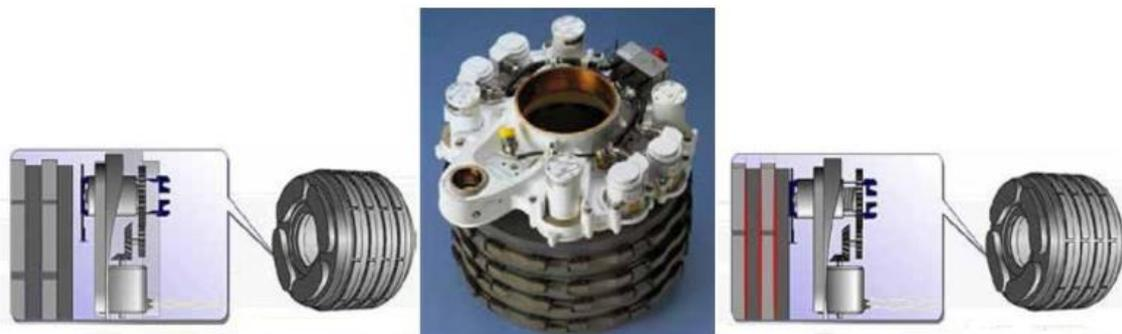
**Figure I.14 : Système de freinage électromécanique du Boeing 787 (Messier Bugatti).**
