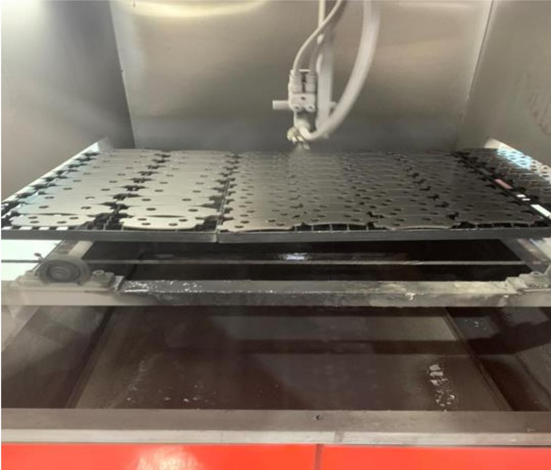
Figure III.9 : Pulvérisation de la colle sur les plaquettes
