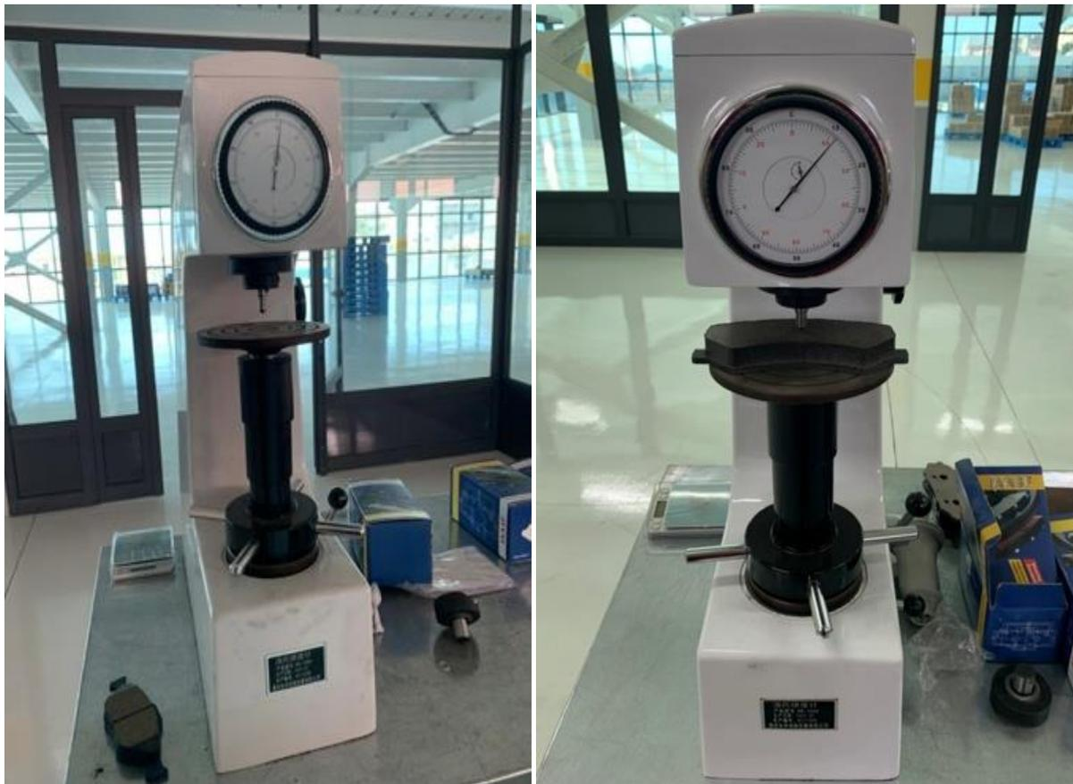
**Figure IV.4 : Testeur de dureté (avant et durant le teste).**
