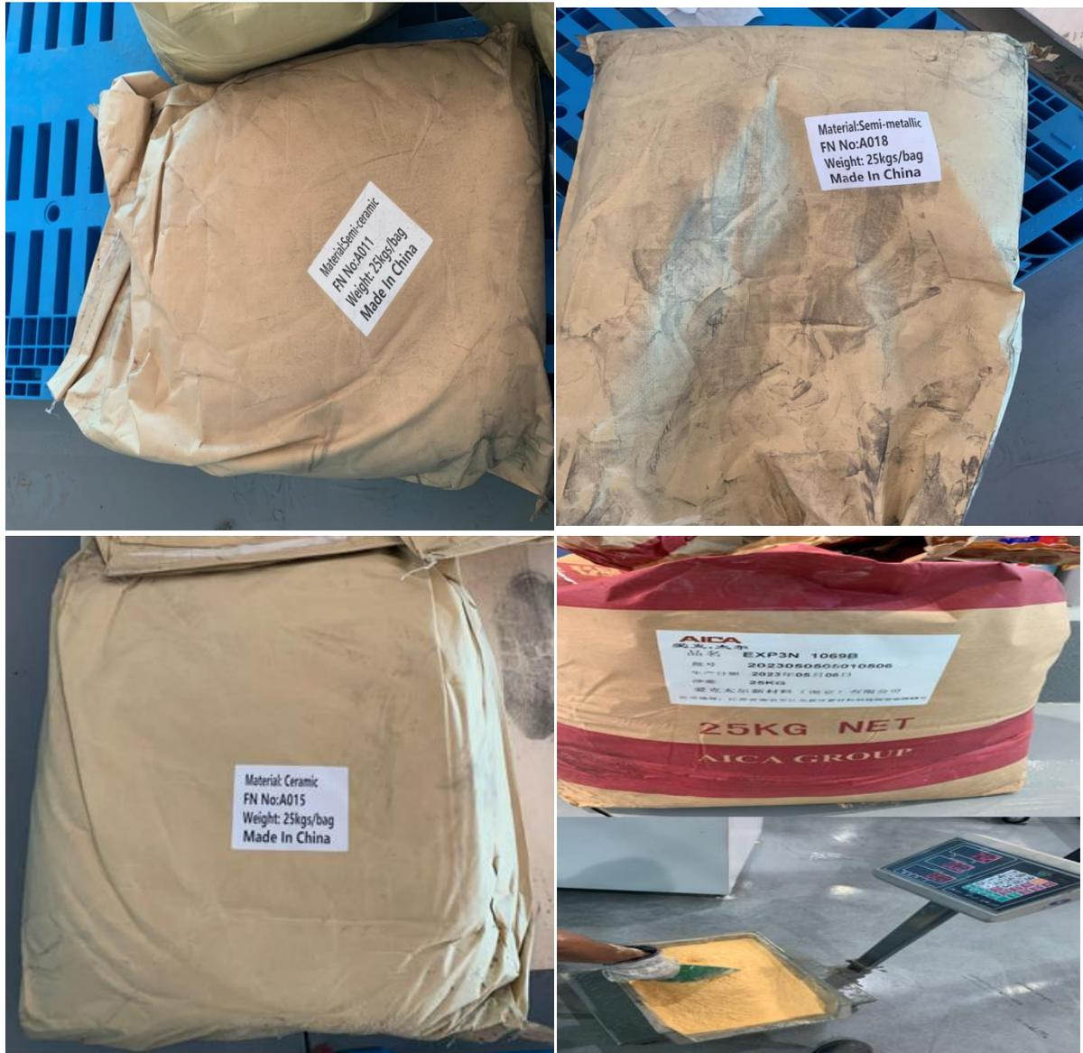
**Figure III.12 : les types de matières de frictions utilisés : semi céramique, semi métallique, céramique, résine.**
