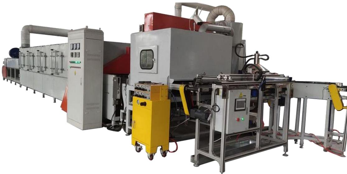
**Figure III.26 : Machine de peinture.**
