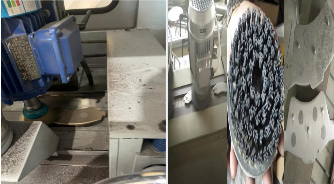
**Figure III.25 : Nettoyage secondaire de la plaquette.**
