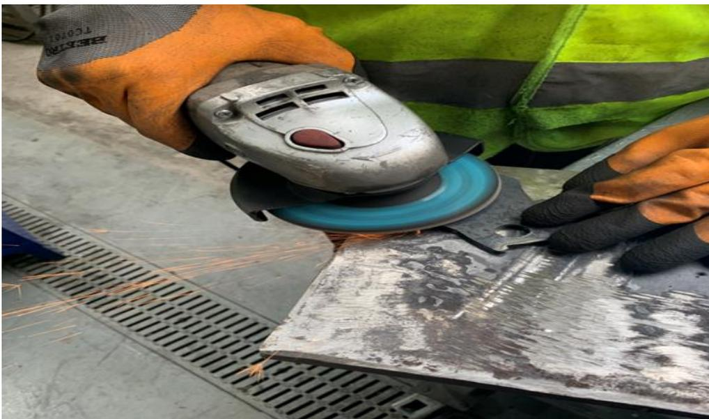
Figure III.3 : Chenfreinage de la plaquette à main.
