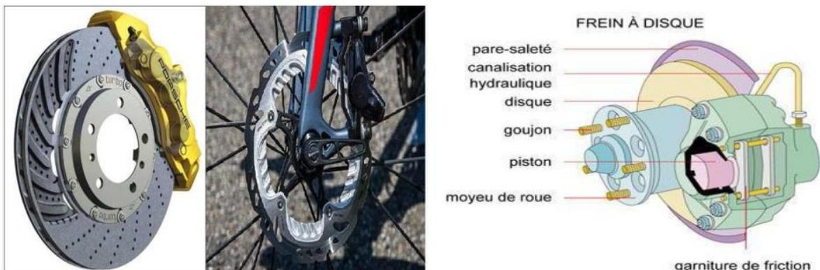
Figure I.12 : Freins à disque.
