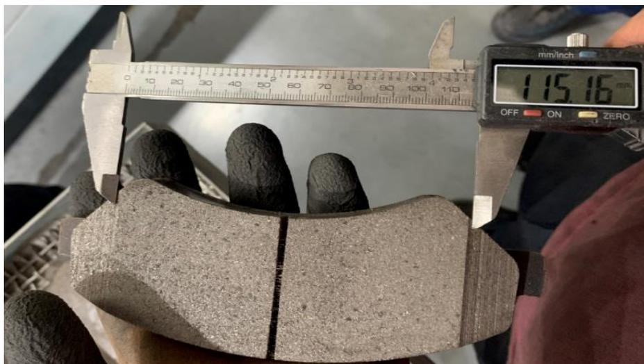
Figure III.24 : Vérification des dimensions de la plaquette rectifiée.
