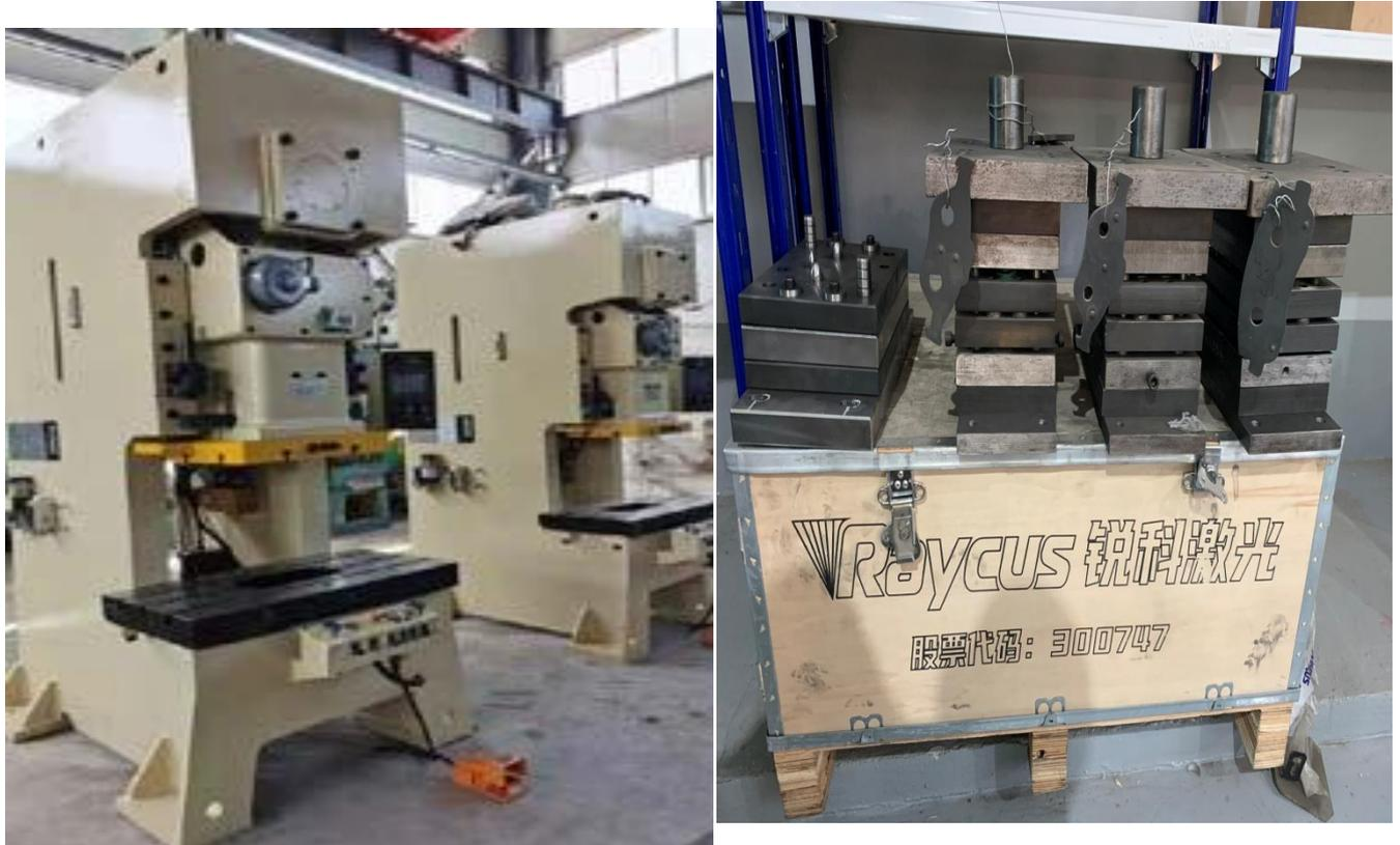
Figure III.5 : Machine de poinçonnage avec les moules.
