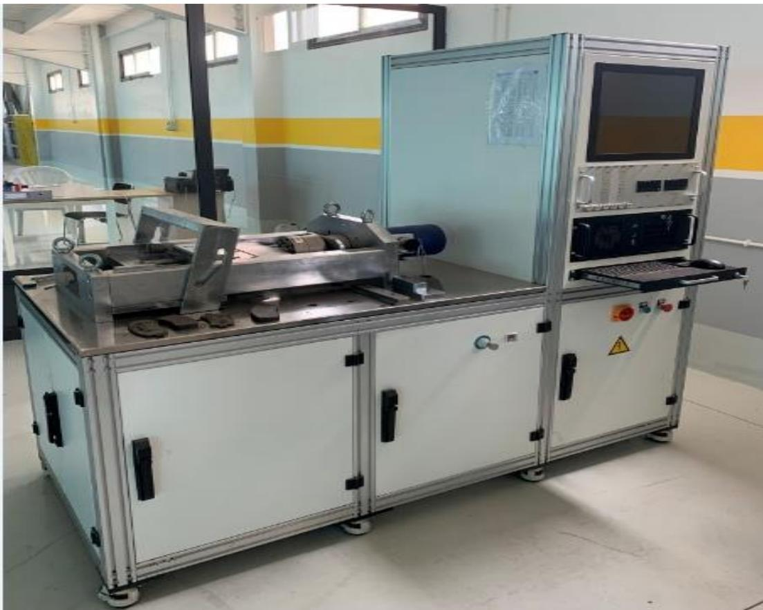
**Figure IV.1 : Machine d'essai de résistance au cisaillement.**
