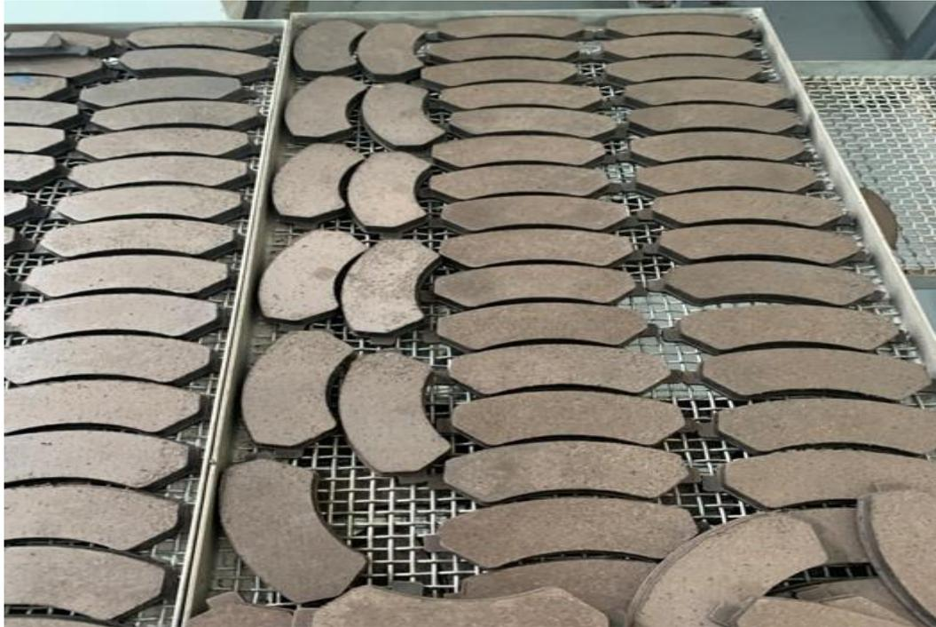
**Figure III.19 : Plaquettes traitées thermiquement.**
