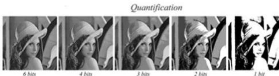
**Figure I- 6 :** Quantification d'une image
