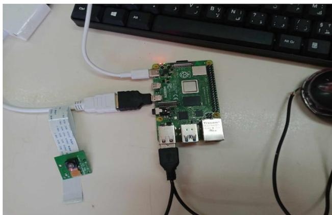
Figure III - 3 : Alimentation d'une carte raspberry avec le PC
