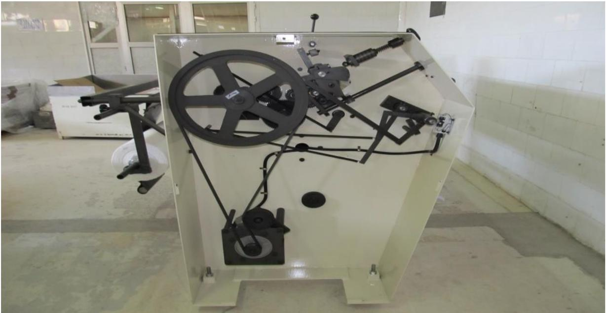
**Figure II.7:Motorisation rouleaux et d'enroulage**
