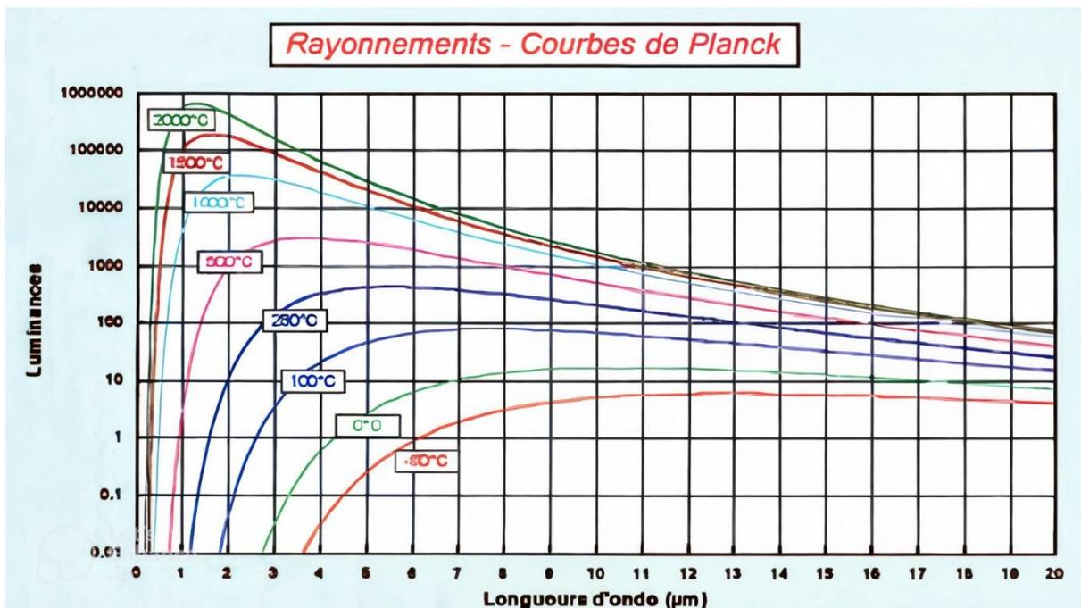
Figure III 4 Emission spectrale radiante d'un corps noir
