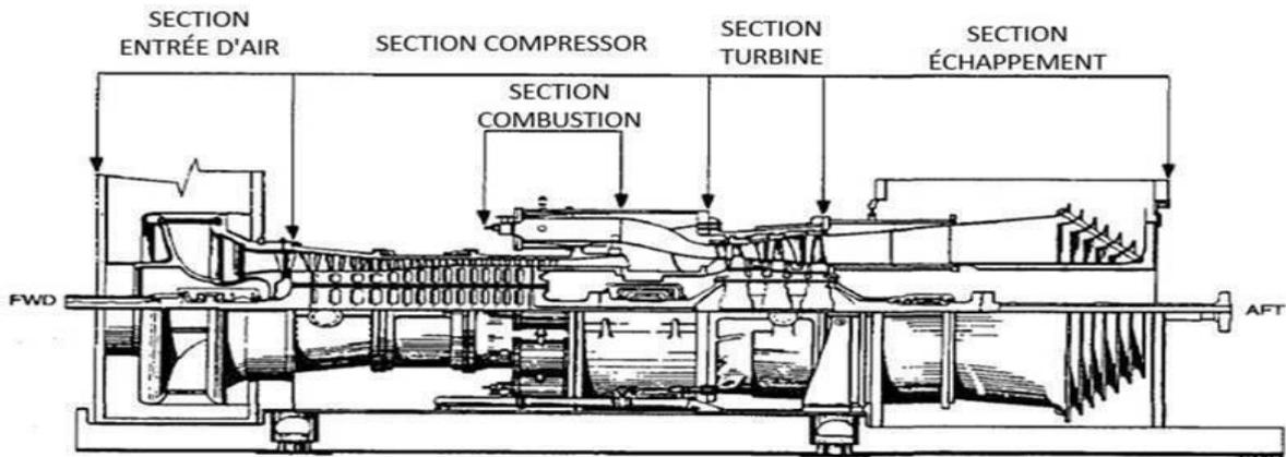
Figure I 7 Composants de la turbine à gaz
