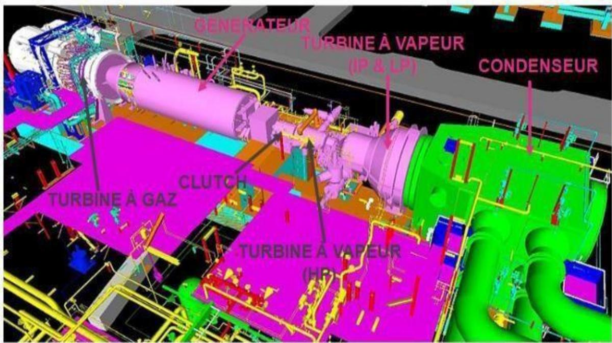
Figure I 3 Vue en section d'un cycle combiné
