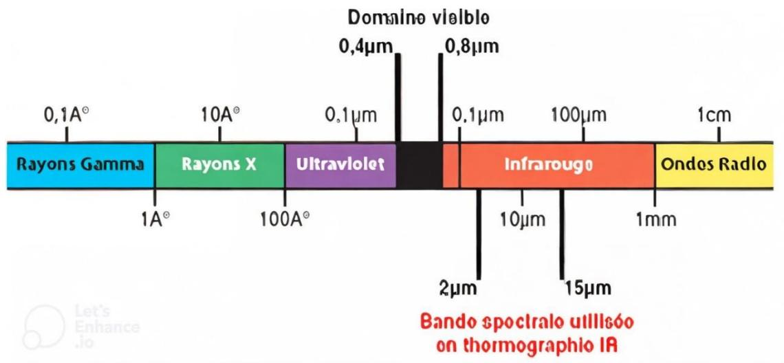
**Figure III 3** spectre électromagnétique
