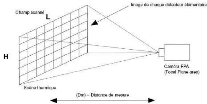
**Figure III 7** La caméra à mono-détecteur
