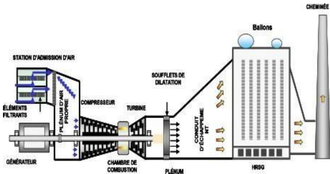
Figure I 6 Schéma de turbine à gaz en mode cycle combiné
