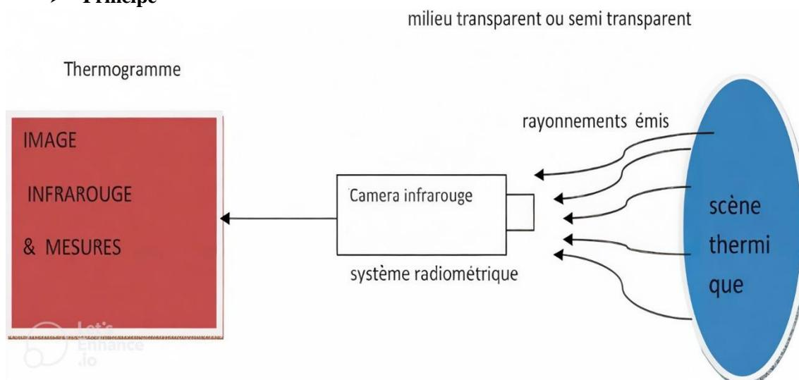
Figure III 6 principe de fonctionnement de la caméra infrarouge
