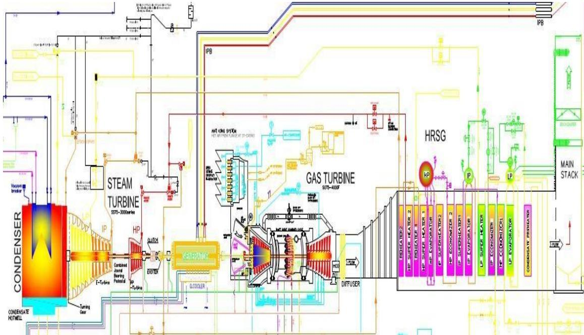
**Figure I 5 :** Cycle de fonctionnement de la nouvelle centrale (cycle combiné) de RAS-DJINET [2]
