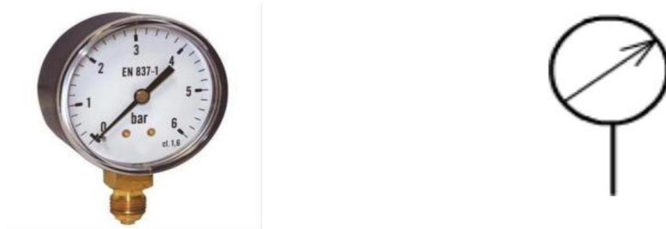
*Figure III44: Symbole d'un manomètre.*
