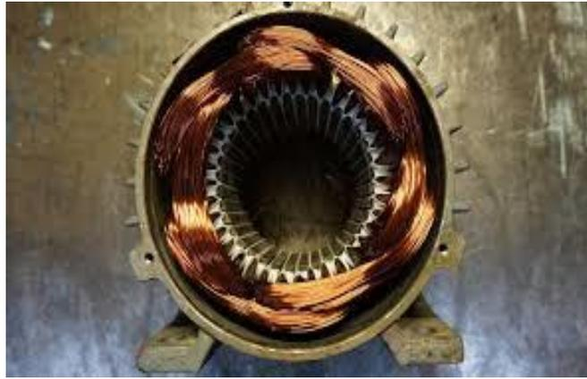
Figure III 20: présentation d'un stator.
