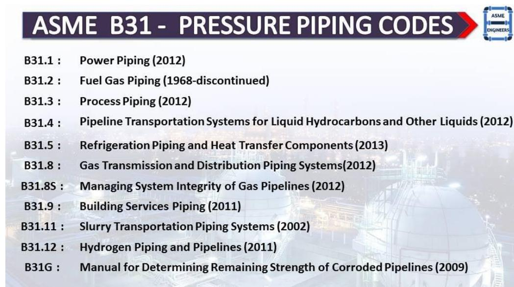
FIG II.2 : ASME B31 Pressure Piping Codes
