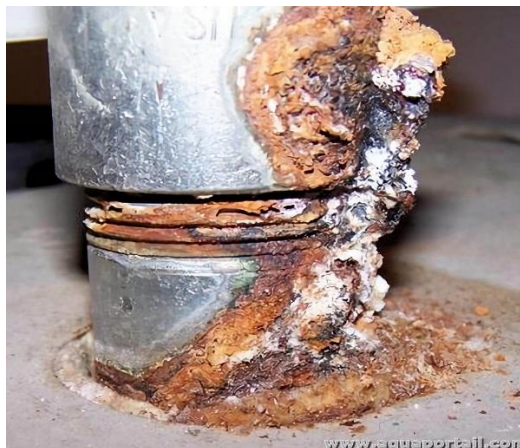
Figure 23 : Effet d'une eau agressive sur une conduite
