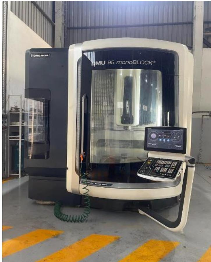
*Figure IV. 1 : Machine DMU 95 Monobloc à 5 axes (SFT)*
