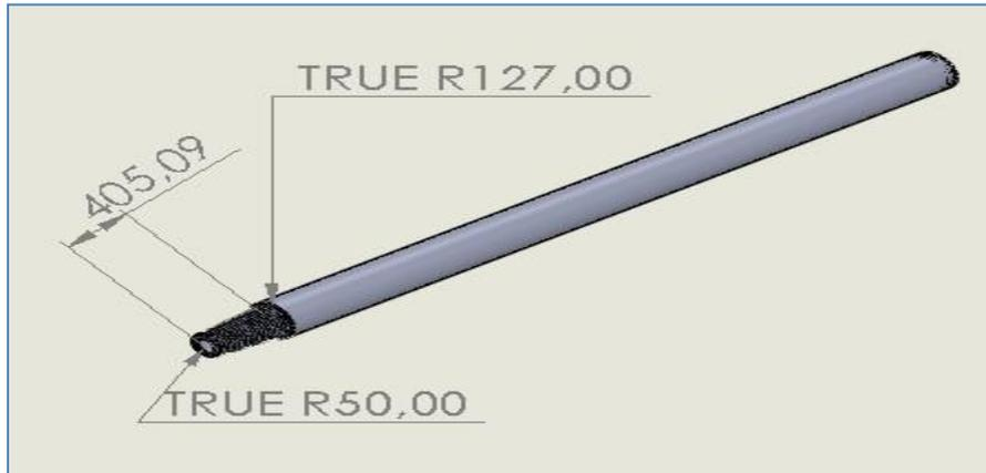
*Figure II. 3: Tige de forage dessinée avec SolidWorks*
