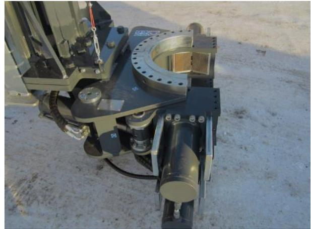
*Figure I. 11 : Nouveau système d'étaux de dévissage des tiges de forage [3]*
