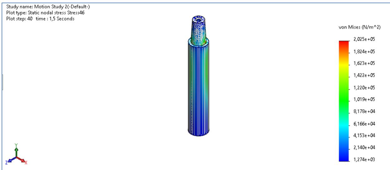
*Figure III. 3 : Distribution des contraintes équivalentes de Von-mises sur la tige*
