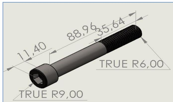
*Figure II. 11 : Vis dessiné avec SolidWorks*
