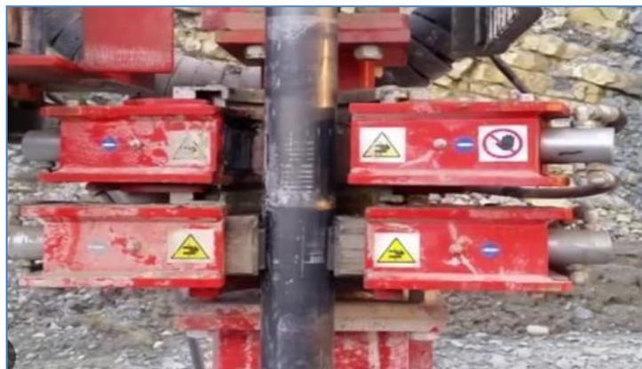
Figure I. 7 : Étau de dévissage sur site [3]
