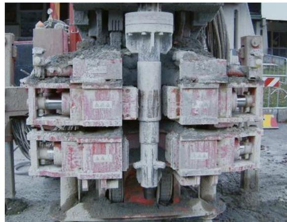
*Figure I. 14 : Étau de dévissage de la tige de forage [3]*
