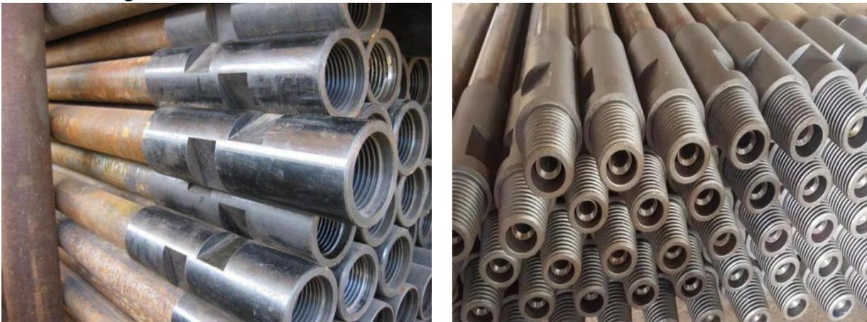
*Figure II. 1 : Tiges de forage*
