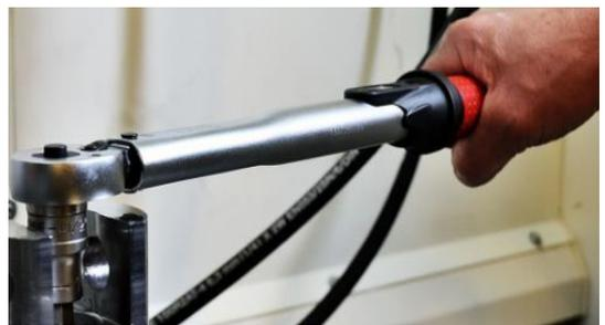
*Figure 1. 10 : Clé dynamométrique*
