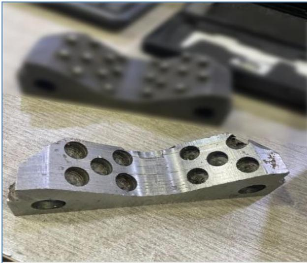
*Figure II. 16 : Arrachement des goupilles de la plaquette*
