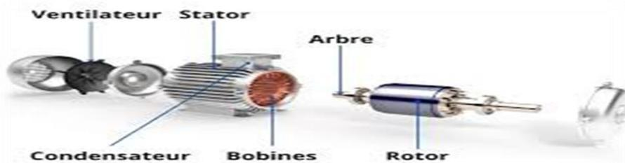
Figure 20 Composantes d'un moteur électrique.
