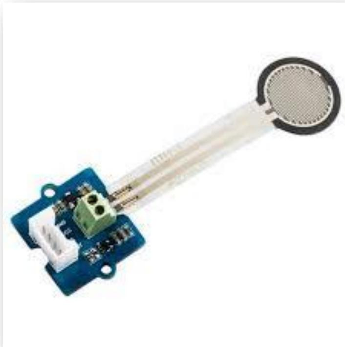
*Figure 74 Capteur de Force.*
