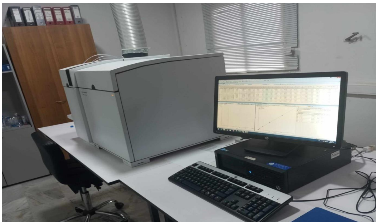
Figure 22 : spectromètre de masse associé à un plasma d'argon à couplage inductif (ICP-MS)
