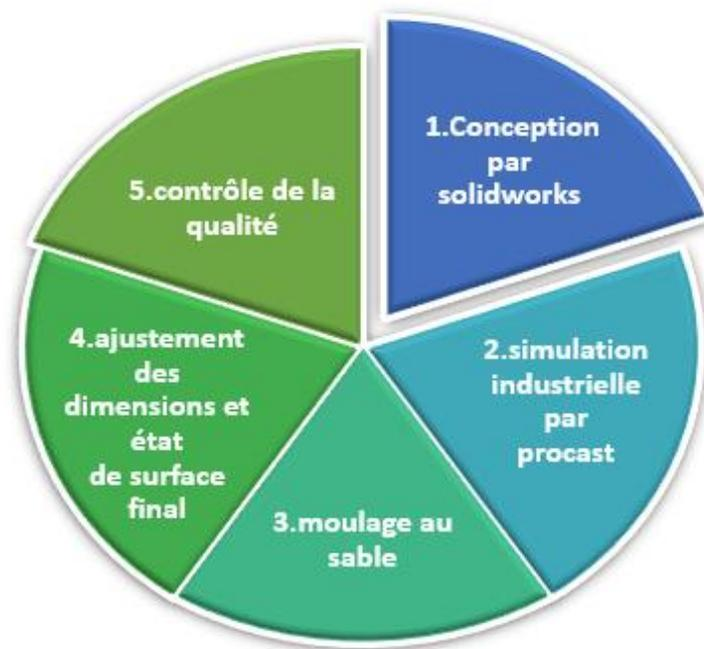
Figure II-2 : Graphique de fabrication d'une pièce moulée.
