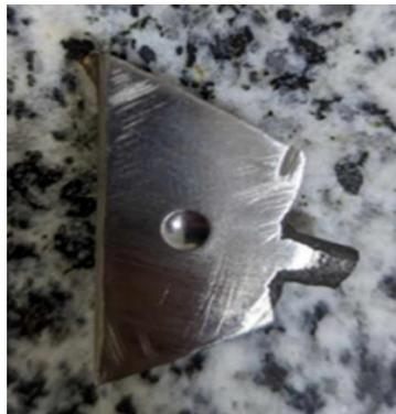
*Figure IV-26 : Résultat de l'essai de dureté.*
