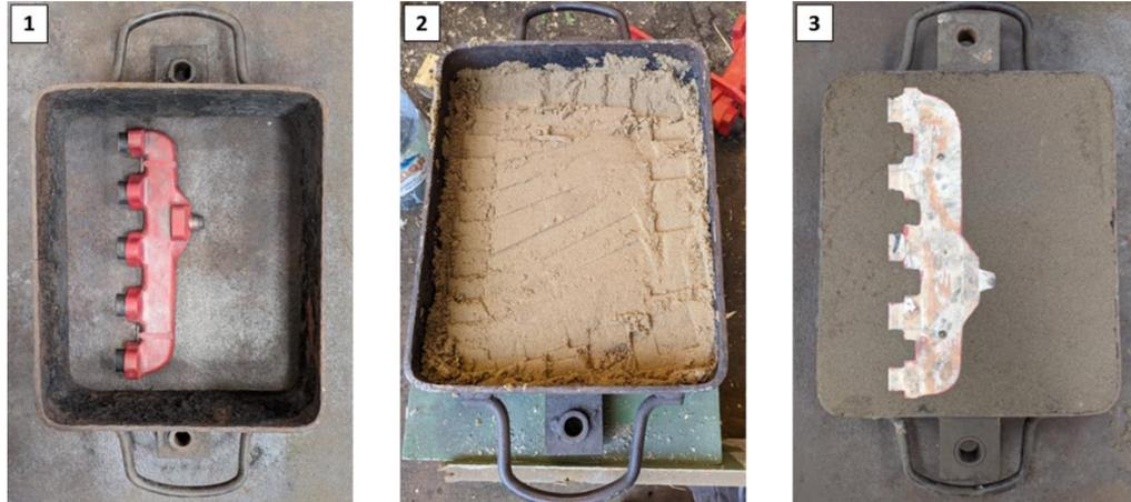
*Figure IV-6: (1) Modèle inférieur dans le châssis inférieur, (2) et (3) remplissage le châssis inférieur.*
