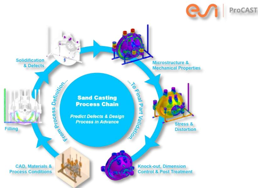
**Figure III-1 : Présente logiciel PROCAST.**
