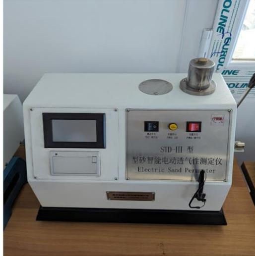
*Figure IV-4 : Appareil de contrôle de perméabilité.*
