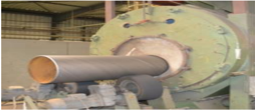
Figure I.18 : La machine du revêtement
