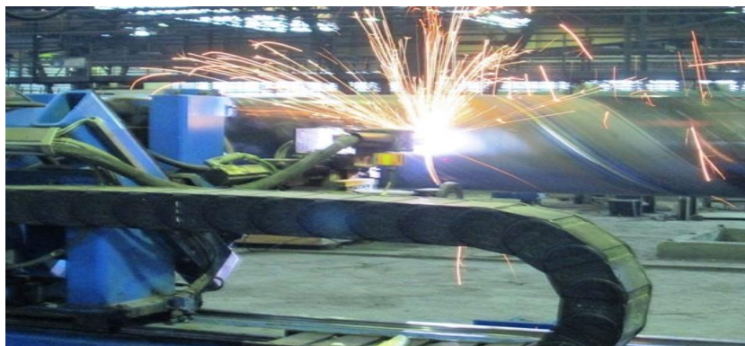
Figure I.7 : coupage par plasma
