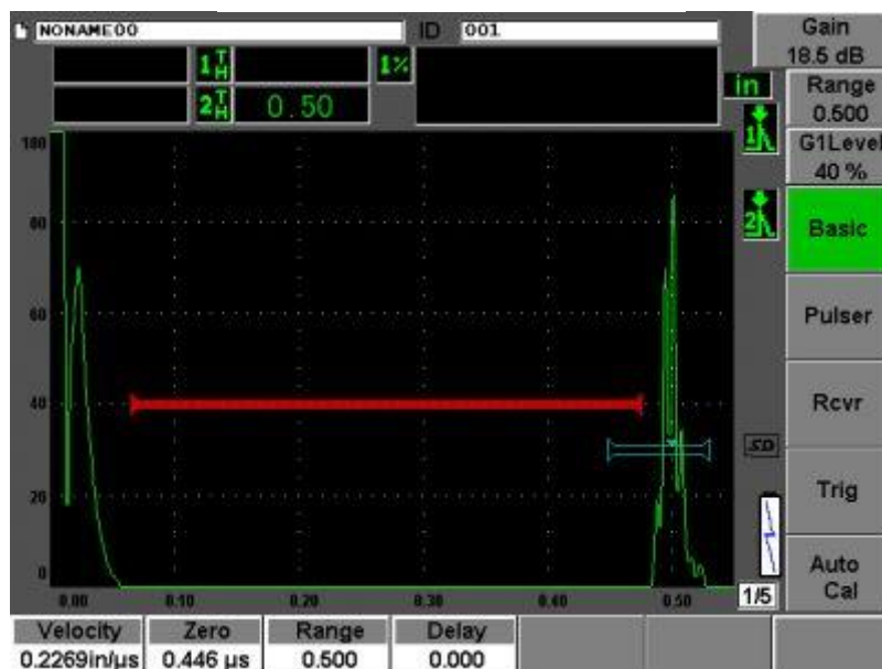
Figure II.3: le signal d'ultrason en absence le défaut
