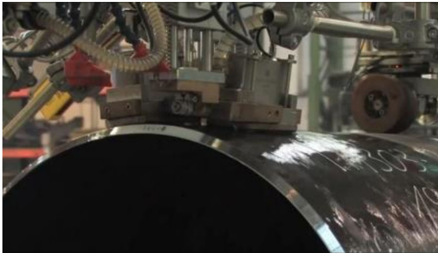
Figure II.17: Test de l'extrémité
