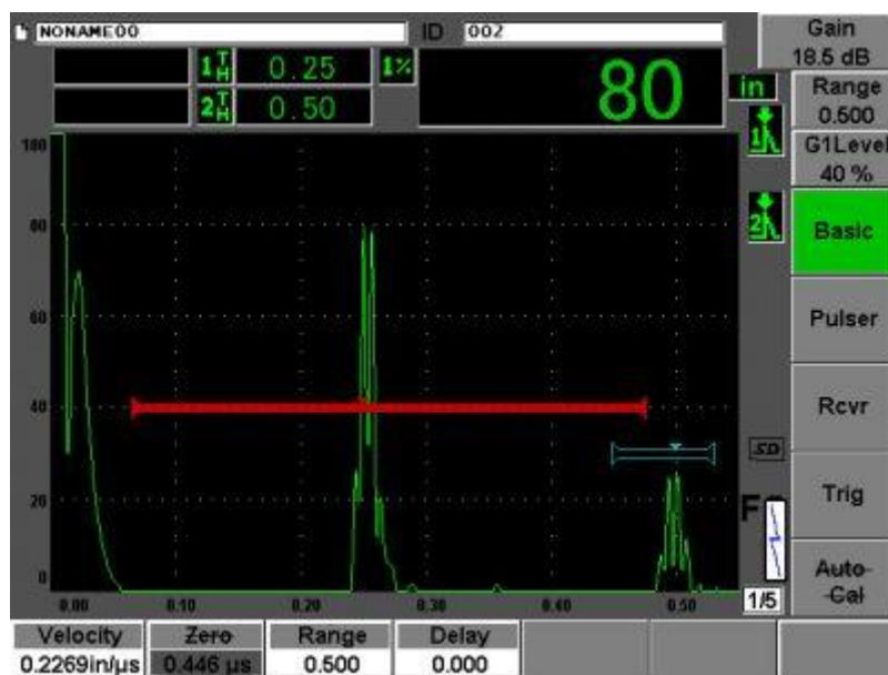
Figure II.5: le signal d'ultrason en présence le défaut
