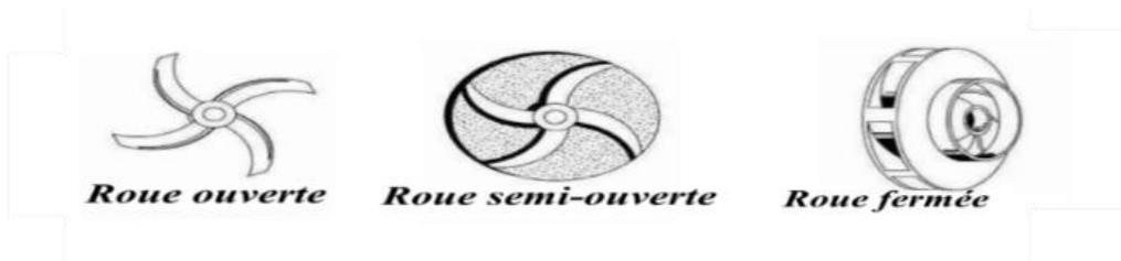
Figure II. 11- Types des roues dans les pompes centrifuges [33]
