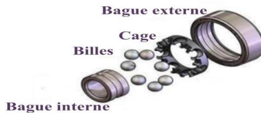
Figure III. 22-Principaux éléments constitutifs d'un roulement. [25]
