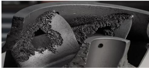
Figure II. 25- Dégâts de la cavitation [43]
