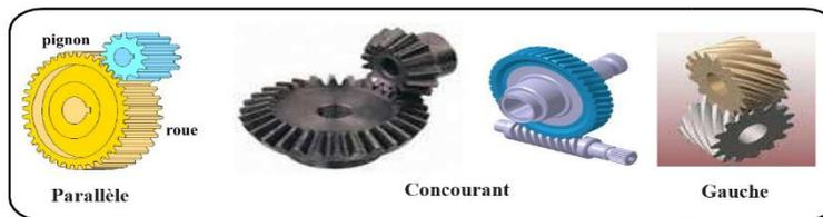
Figure III.17-Différents types d'engrenage [45]
