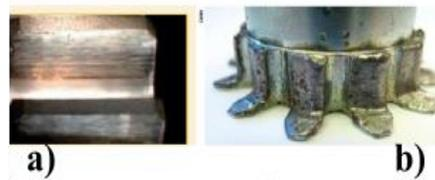
Figure III.18-. L'usure des engrenages a) usure par interférence. b) usure abrasive [26]
