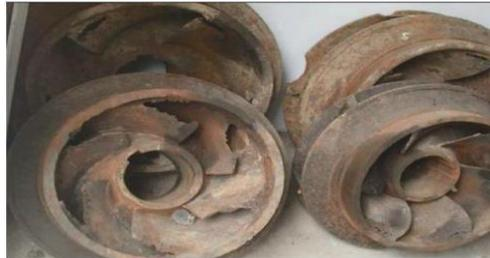
Figure III.24 -Défaillance par cavitation dans les pompes [24]
