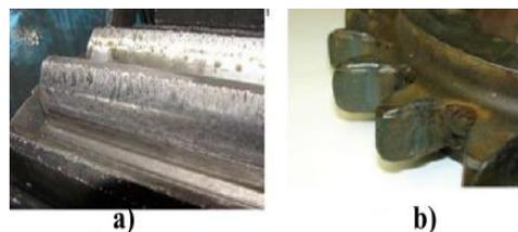
Figure III .21-. Grippage a) à froid, b) à chaud [26]
