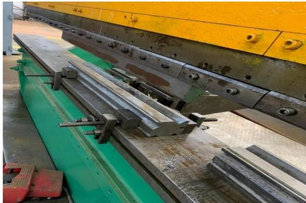
**Figure II.9: Pliage en V**
