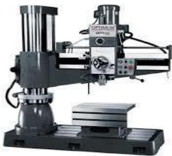
**Figure II.11: Perceuse radiale**
