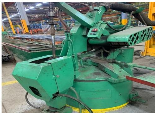
Figure II.5: Découpage par tronçonneuse
