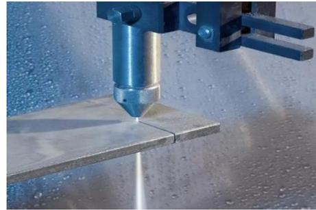
Figure II.2: Découpage jet d'eau. [4]
