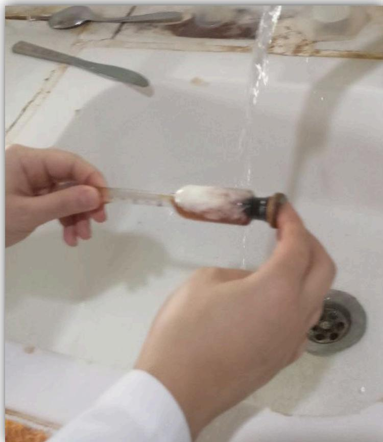
**Figure 09 :** butyromètre pendant l'agitation
