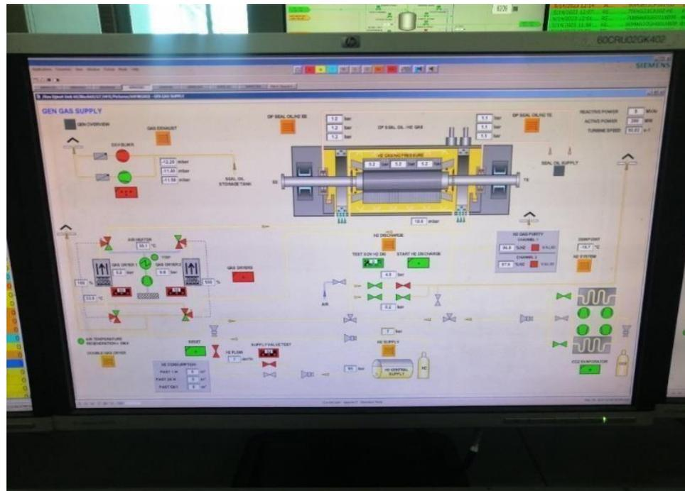
Figure I.11. Circuit de refroidissement d'alternateur
