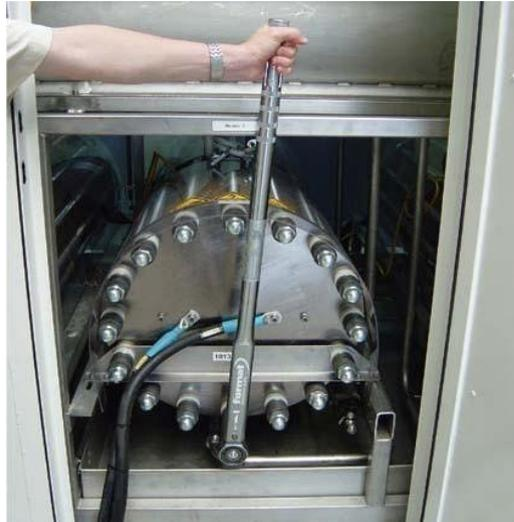
Figure III.5. Contrôle du couple sur la pile de cellules [12]
