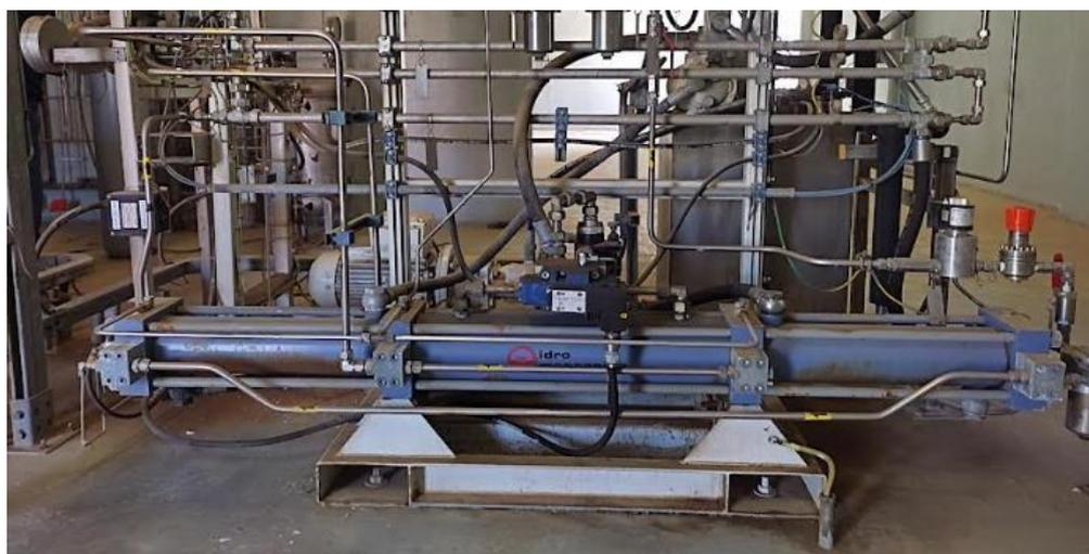
Figure II.4. Compresseur à piston double effet
