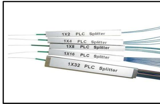
Figure II. 15 :Splitter optique[30]
