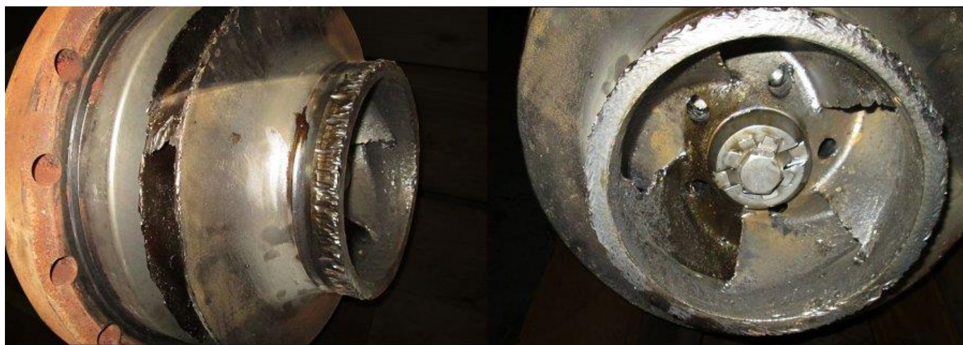
Figure B.4 Corrosion par érosion-cavitation
