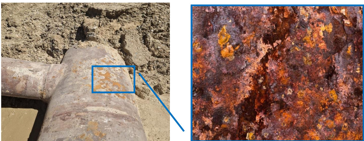
Figure II.2 Illustration de la corrosion chimique.
