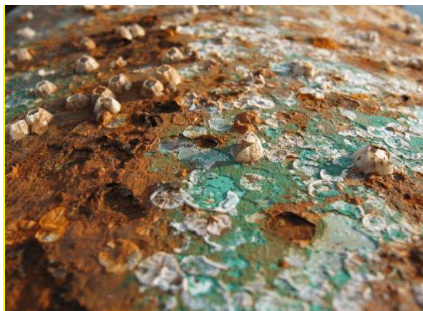
Figure B.1 La corrosion biochimique
