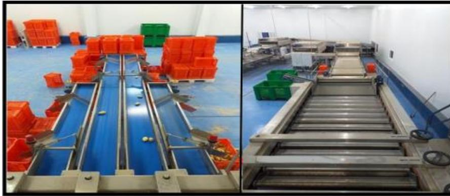
*Figure I.3 : Système de tri des produits agricoles par la machine CALIBREUSE [5].*
