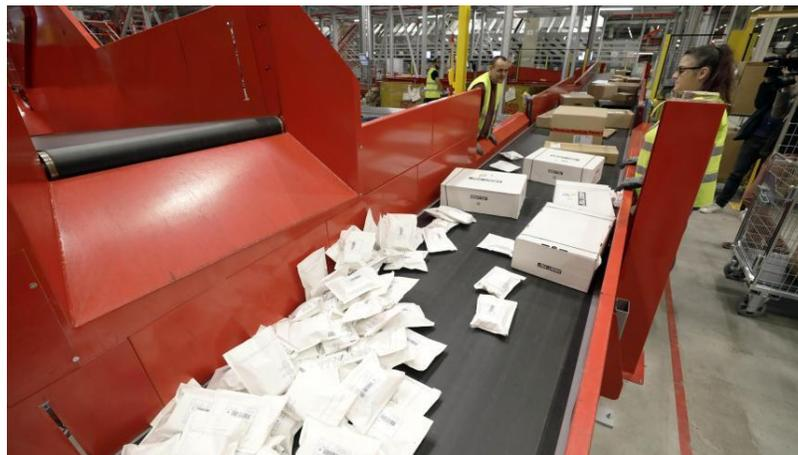
**Figure I.5 :** Installation industriel automatisée pour le tri des colis [9].
