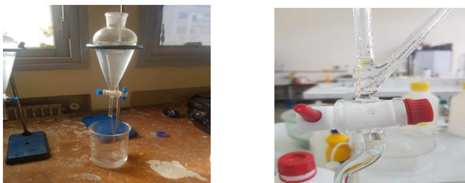
Figure 8. Séparation des huiles essentielles par décantation
