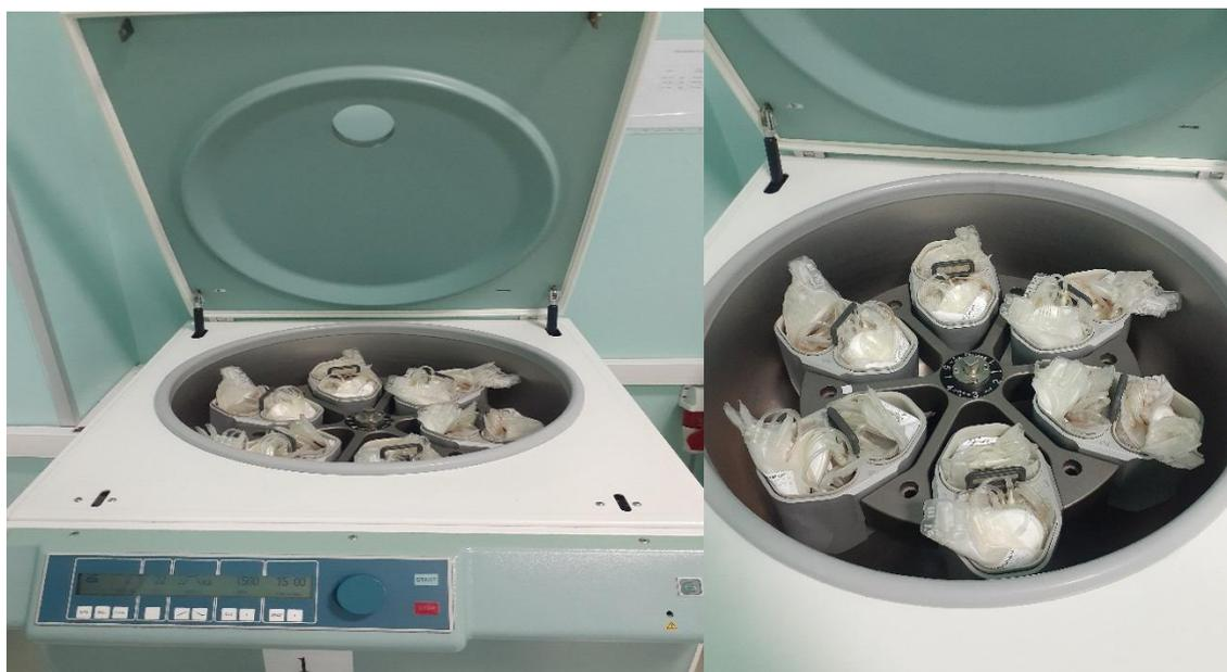
**Figure 15:** Poches pliées puis mises en pot dans la centrifugeuse CTSA Alger .
