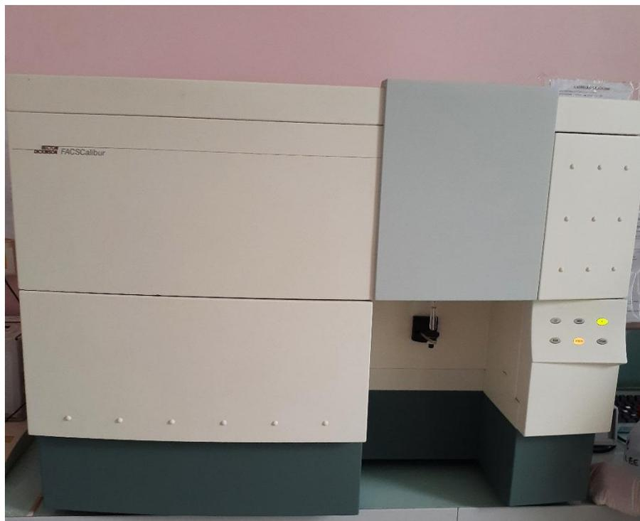
**Figure 22:** Automate de cytométrie en flux (FACSCalibur De Becton Dickinson)
