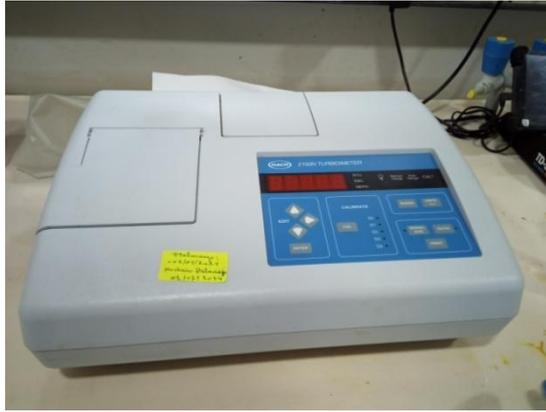
**Figure IV.25 :** Turbidimètre.
