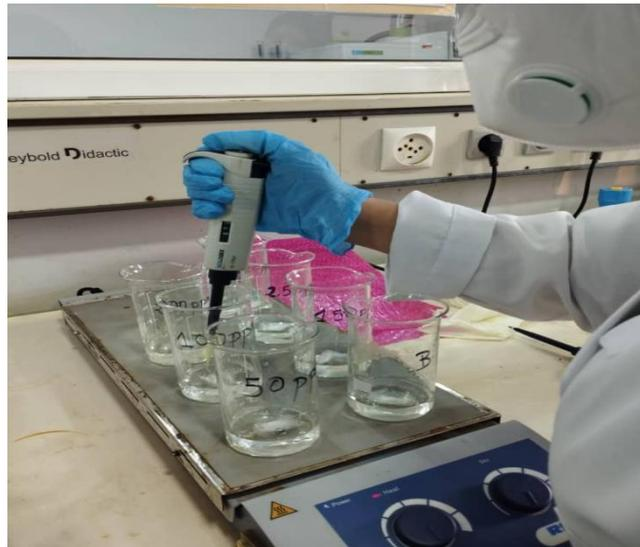
**Figure IV.21 :** L'injection de l'inhibiteur.
