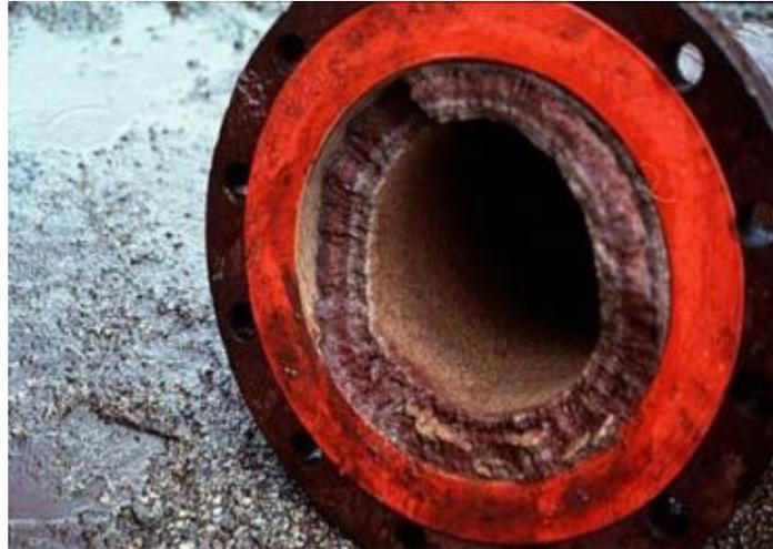
Figure III.3: dépôts de sulfate de calcium.
