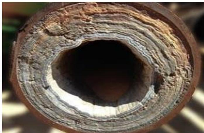
**Figure III.2:** Dépôt de sulfate de baryum.
