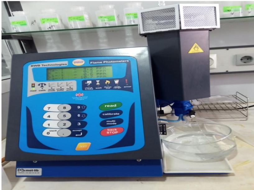
**Figure IV.11:** Spectrophotomètre de flamme
