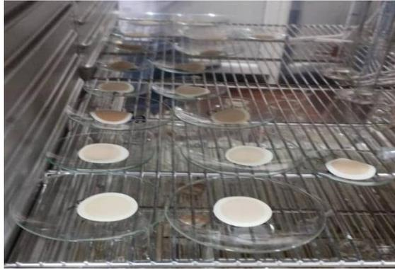
**Figure IV.18:** Disposition des filtres avec dépôts dans l'étuve pour le séchage
