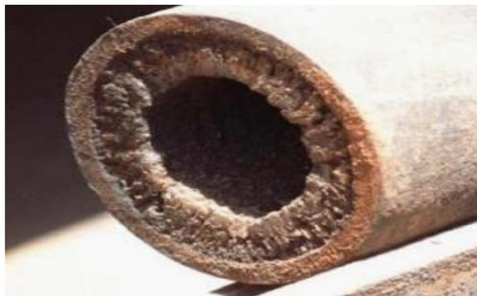
Figure III.4: dépôts de sulfate de strontium
