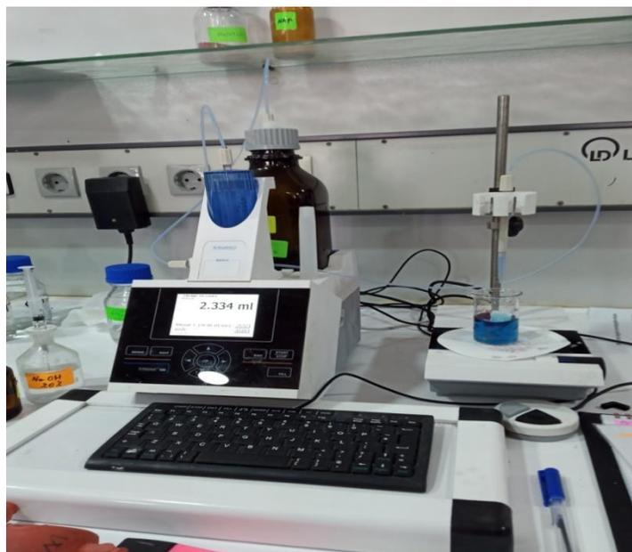
Figure IV.8: Dosage de magnésium par complexométrie
