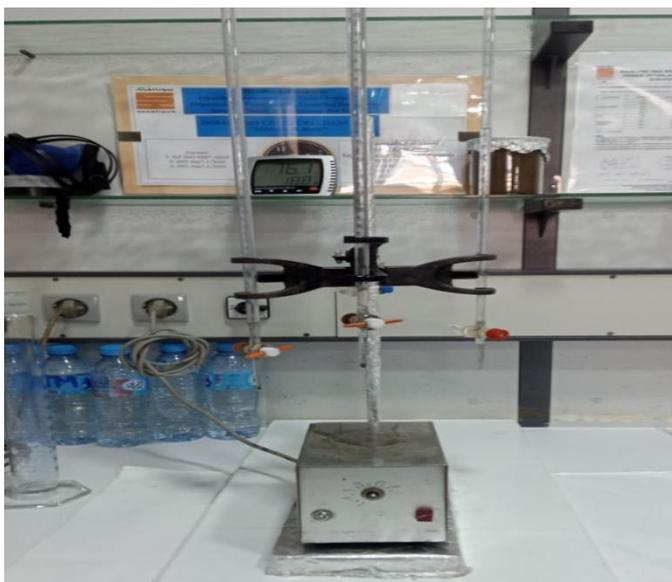
**Figure IV.4 :** Dosage des chlorures par l'application de la méthode de MOHR.
