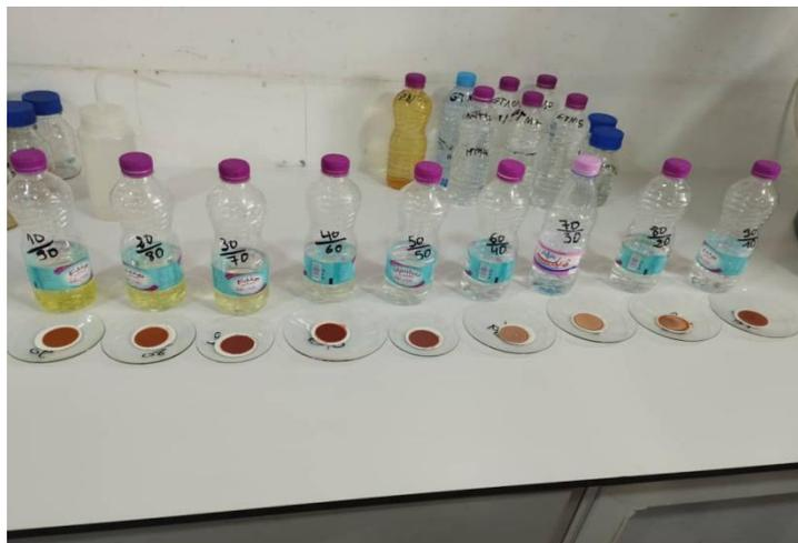
**Figure IV.20:** Photo de Dépôt du sel sur les filtres et la récupération du filtrat.
