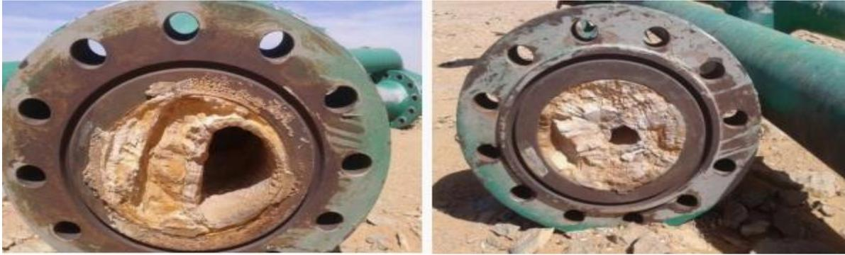
Figure II.1: Dépôts de BaSO<sub>4</sub> dans les conduites. [17]
