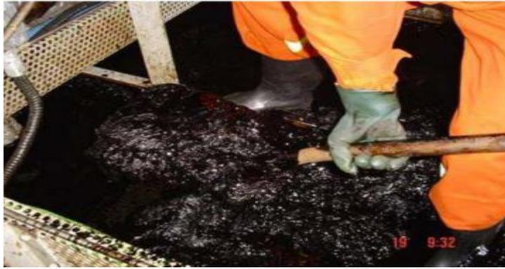
**Figure II.2 :** Dépôt d'asphaltènes induit par un changement de composition. [19]
