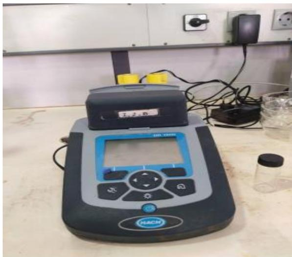
**Figure IV.10:** Spectrophotomètre DR1900
