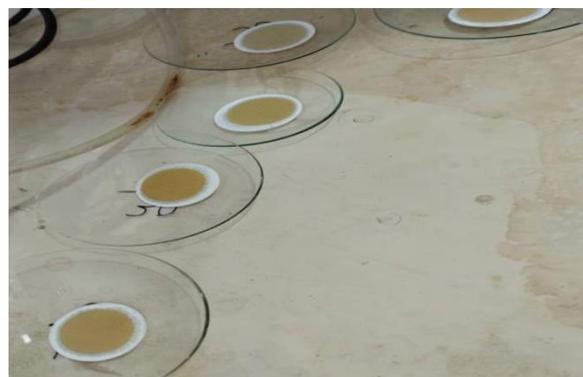
**Figure IV.17:** Dépôt du sel sur des filtres.
