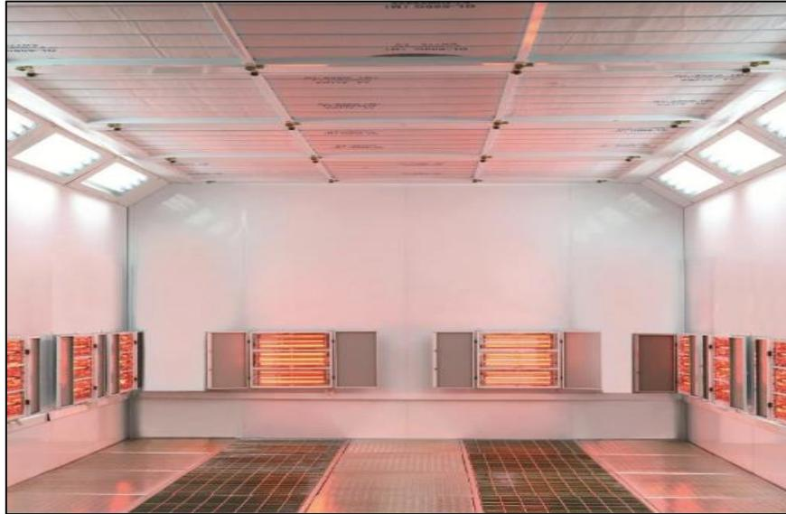
Figure II.4 : Système de chauffage d'une cabine peinture.
