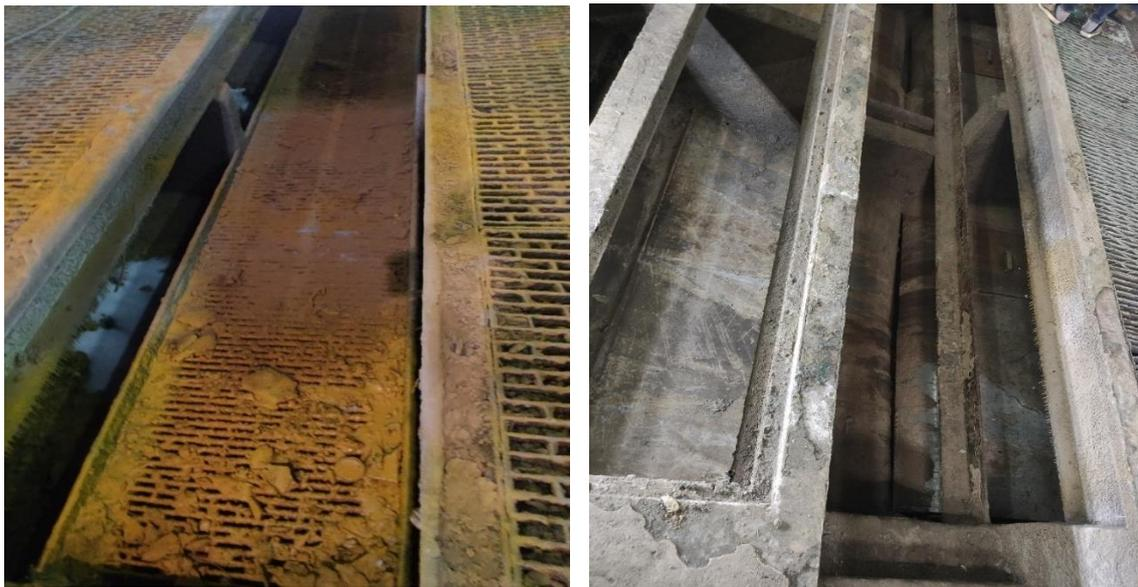
Figure V.6 : la zone de lavage d'air (la fosse) de la cabine peinture humide.
